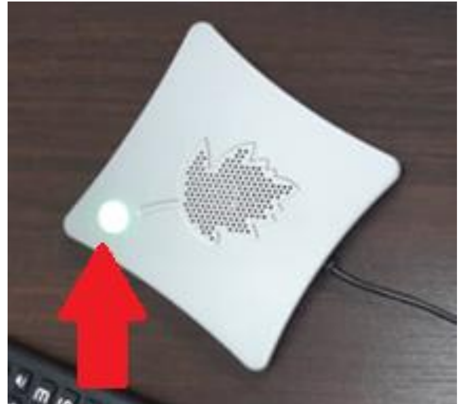
Figura 16 - Indicação de como desligar o microfone de mesa (Fonte: Elaborada pela PROPLAN)
